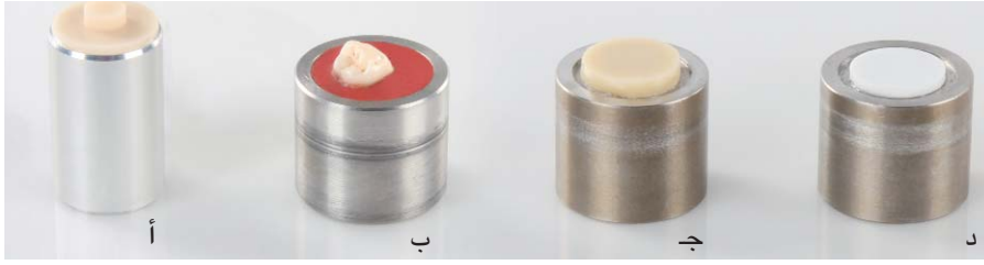
الصورة ٣: أ - كتلة الإحتكاك و العينات المختلفة ، ب - السن الطبيعي، ج - ICE Zirkon Keramik ، د - Prettau Zirkon
