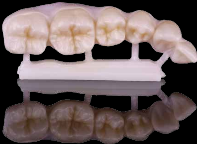
Фрезерование с помощью системы CAD/CAM 5-TEC производства «Цирконцан» без ручной доводки
