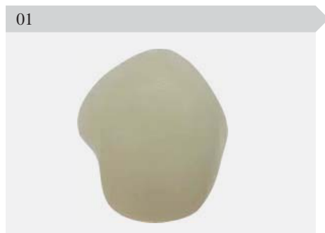
Piaskowanie powierzchni (100 µm; 4 bar)
