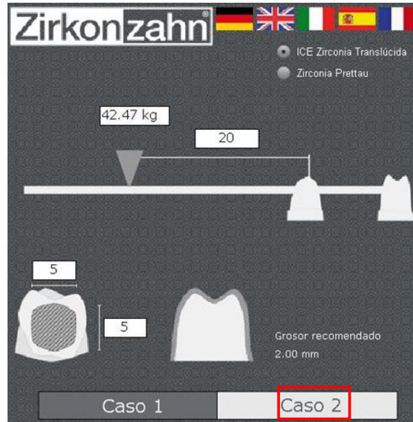
Caso 2 simula dos o más muñones, uno al lado de otro, seguido por un puente cantilever.
